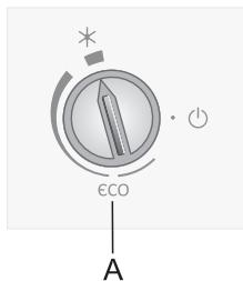
Включайте функцию «Быстрое замораживание» при первом включении прибора, перед очисткой и за 24 часа до загрузки большого количества продуктов.
