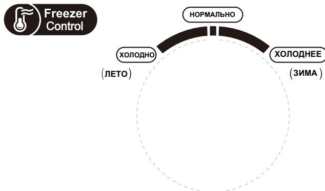
Температура замерзания относительно низкая в положении "ХОЛОДНЕЕ", в то время как температура замерзания относительно высокая в положении "ХОЛОДНО", таким образом, обычно используется "НОРМАЛЬНОЕ" положение.
