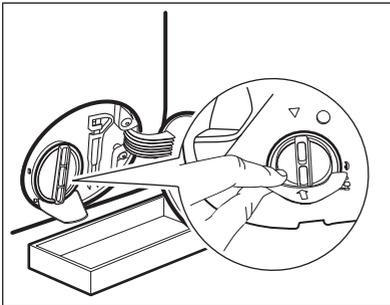
4. Чтобы снять фильтр, поверните его против часовой стрелки на 180 градусов, не вынимая. Дайте воде вытечь.
