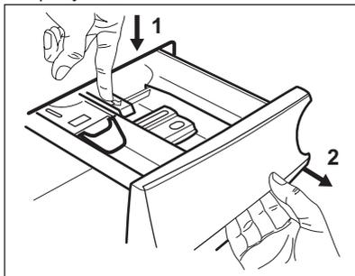
2. Для упрощения очистки снимите верхнюю часть отделения для добавок и промойте его под струей теплой воды, чтобы удалить все следы скопившегося моющего средства. После очистки установите верхнюю часть на место.
