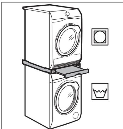
Сушильный барабан можно установить поверх стиральной машины **только при помощи подходящего комплекта для**
