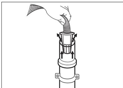
5. **Без помощи пластиковой направляющей для шланга, к сливному отверстию сливной трубы** - Вставьте сливной шланг в сливную трубу и закрепите муфтой. См. Рисунок.
