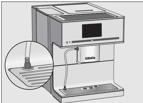
■ Вставьте молочную трубку в отверстие в декоративной пластине.
