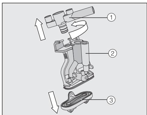
■ Поверните вверхнюю часть ① с разъемом для молочной трубы и вытяните эту часть. Снимите также деталь в форме Y ②. Отсоедините выпускные форсунки ③.
