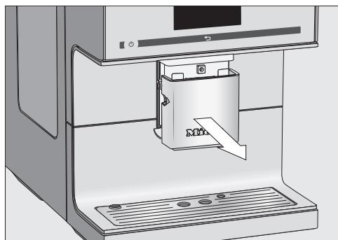
■ Снимите стальную облицовочную деталь (крышку), отводя ее вперед.
