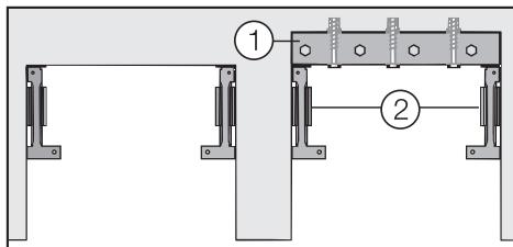
Если ниша глубже, чем прибор, установите массивную деревянную балку ① сзади крепления от опрокидывания ② и прикрепите ее к полу или к стене.
