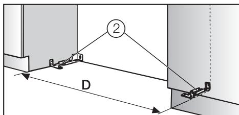
Расстояние "D" между креплениями ② в точности соответствует ширине прибора.
