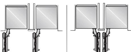
Если между приборами, расположенными рядом, есть промежуточная стенка толщиной **между 16 мм и 160 мм**, то приборы поочередно крепятся прилагаемыми монтажными материалами в нишу. Дополнительно потребуется монтажный комплект Side-by-side.
