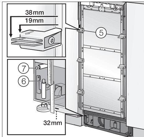
Вспомогательные установочные элементы ⑤ на дверце прибора расчитаны на толщину мебельного фронта 19 мм или 38 мм.
