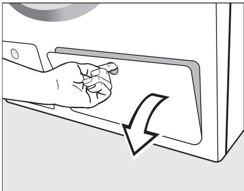
■ Для открывания потяните крышку отсека TwinDos.
