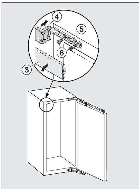
■ Снимите заглушку ③ с верхнего угла прибора с помощью отвертки.
