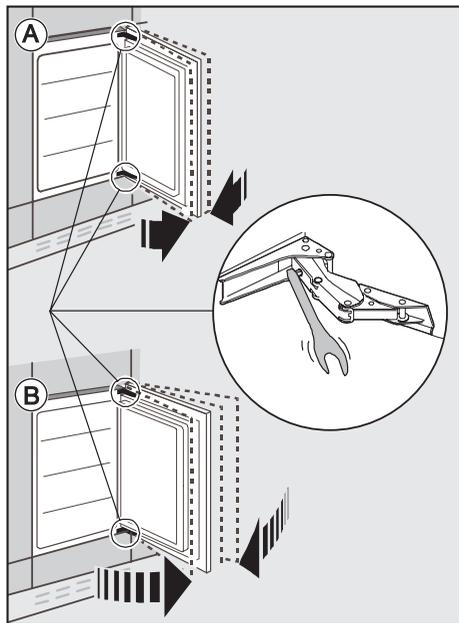
для этого отрегулируйте дверной шарнир с помощью прилагаемого торцевого ключа с внутренним шестигранником.
