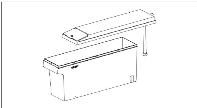
2. Снимите крышку резервуара для воды.
