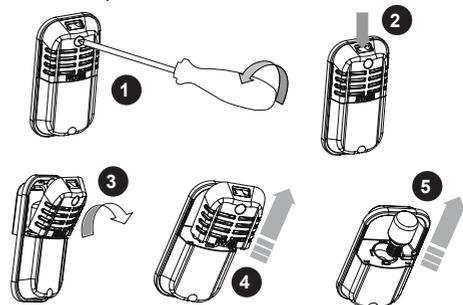
1. Отверните винт на крышке с помощью отвертки. (Рис. 1)
