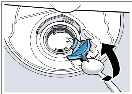
6. Приподнимите крышку насоса, направив ее наискось вовнутрь, и снимите.
