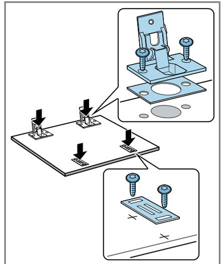
5. Die Gegenplatten der Magnetschnapper anschrauben.
