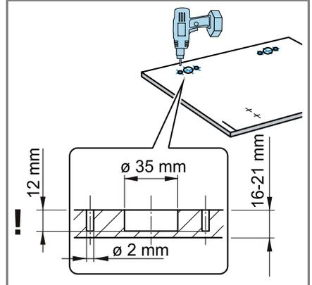
4. Die Scharniere in die Bohrlöcher einsetzen und anschrauben.
