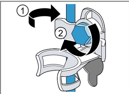
5. Den Schlauch in die Halterung einsetzen.
