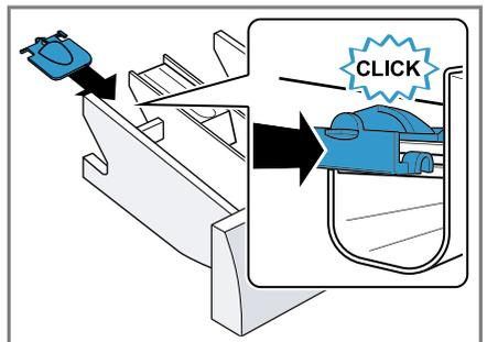
4. Die Waschmittelschublade einsetzen.
