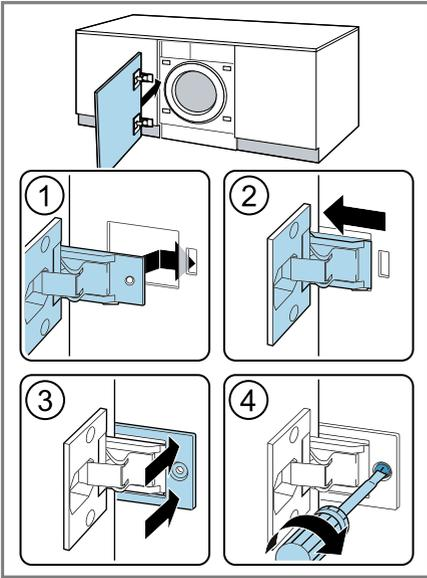
7. Die Abdeckschiene einschieben ③ und anschrauben ④.
