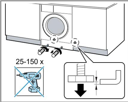
8. Das Gerät mit einer Wasserwaage ausrichten.
