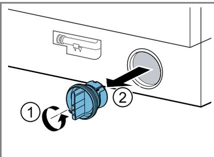
2. Den Innenraum, das Gewinde des Pumpendeckels und das Pumpengehäuse reinigen.
