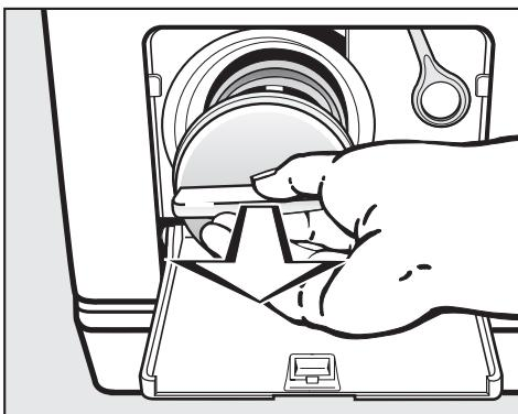
⚠ Если сливной фильтр не будет установлен и плотно завернут, то вода будет вытекать из машины.
