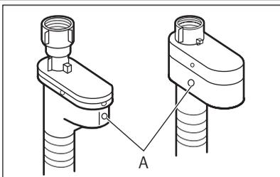
Prívodná hadica obsahuje zariadenie proti vytopeniu. Toto zariadenie zabraňuje priesakom vody z hadice v dôsledku prirodzeného starnutia. Červená časť v okne «A» znázorňuje túto chybu. V takom prípade zatvorte vodovodný ventil a obráťte sa na servisné stredisko a požiadajte o výmenu hadice.
