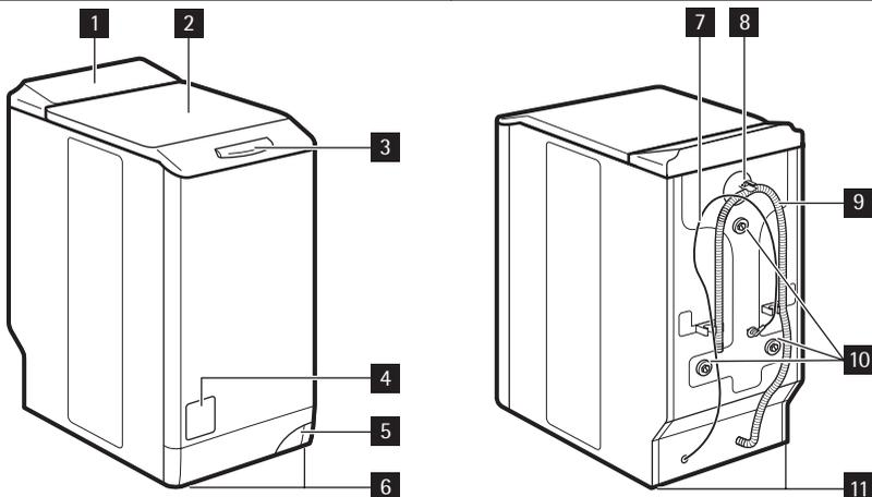
**1** Панель управления**2** Крышка**3** Ручка крышки**4** Крышка фильтра**5** Рукоятка для перемещения прибора**6** Регулируемые ножки**7** Сетевой кабель**8** Входной клапан подсоединения к водопроводу**9** Сливной шланг**10** Транспортровочные болты**11** Ножки для выравнивания прибора
