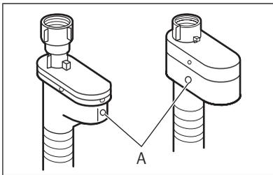
Наливной шланг оснащен устройством для защиты от протечек воды. Это устройство предотвращает протечки, которые могут иметь место по причине естественного старения шланга. О возникновении такой неисправности предупреждает появление красного сектора в окне "А".
