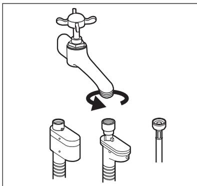
2. Prívodnú hadicu pripojte k vodovodnému kohútiku so studenou vodou s 3/4" závitom.
