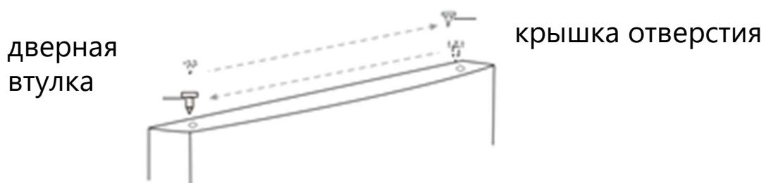
10. Удалите винт, который крепит крышку отверстия для винта петли в верхней левой части корпуса, снимите крышку и закрепите крышку в верхней правой части корпуса.
