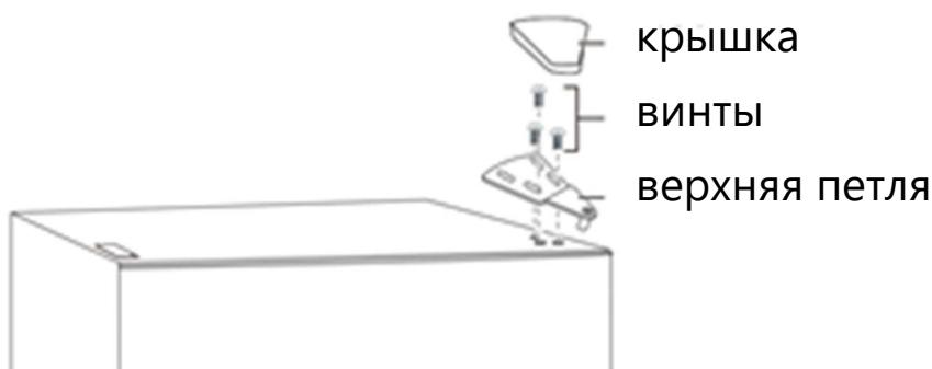
2. Снимите дверь морозильной камеры.
