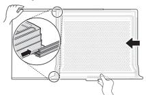
Удерживайте крышку двумя руками и слегка наклоните при установке на место.
