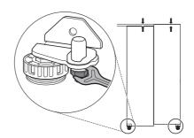
Откройте дверь и с помощью гаечного ключа 1 отверните фиксирующую гайку влево.
