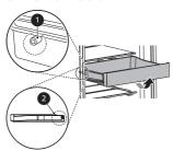
Поднимите ящик морозильной камеры и потяните за него, чтобы извлечь его из холодильника.
