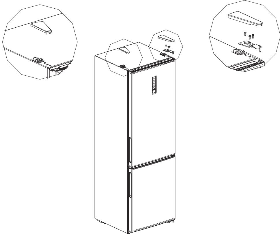
3. Снимите среднюю петлю, винты, заглушки для винтов и снимите дверцу морозильной камеры.
