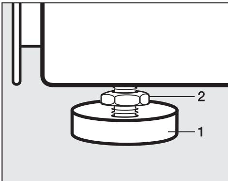
должна быть установлена вертикально и равномерно на четырех ножках.
