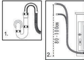
**!** Արտահոսքի փողրակը չի կարելի ընկղմել ջրի մեջ, այն պետք է ապահով ամրացնել և հետևել, որ արտահոսք չլինի: Եթե արտահոսքի փողրակն ընկած է հատակին կամ արտահոսքի համար խողովակի բարձրությունը կազմում է 80 սմ-ից քիչ, մեքենայի մեջ ջրի լցման ժամանակ ջուրն անդադար կթափվի (ինքնաարտահոսք):
