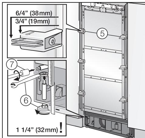
Вспомогательные элементы для установки ⑤ на дверце прибора рассчитаны на следующую толщину мебельного фронта:
