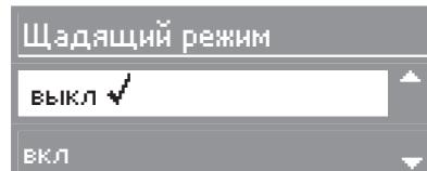
Текст на дисплее может быть плавно перемещен с помощью кнопок **V** или **A** вверх или вниз. С помощью кнопки **OK** выбирается отмеченное значение.
