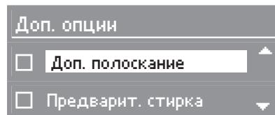
Текст на дисплее может быть плавно перемещен с помощью кнопок **V** или **A** вверх или вниз. С помощью кнопки **OK** выбирается отмеченное значение. Теперь, при желании, может быть выбрано следующее значение.
