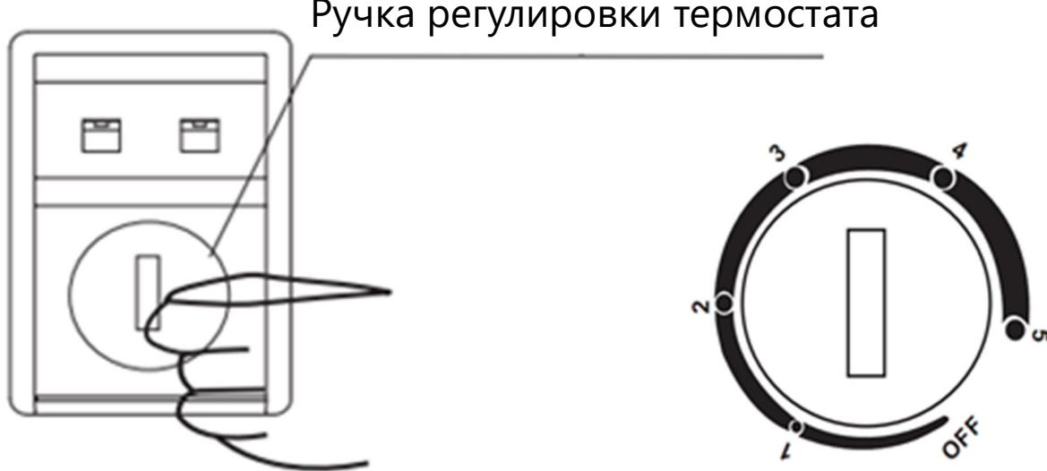
Температура морозильной камеры регулируется с помощью ручки, установленной на термостате. Цифры указанные на термостате «1, 2, 3, 4, 5» не обозначают конкретную температуру. Чем меньше цифра, тем выше температура:
