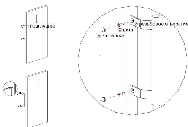
Снимите заглушки (1), закрывающие отверстия для винтов.
