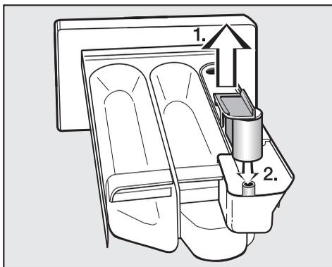
1. Вытяните сифон из ячейки
