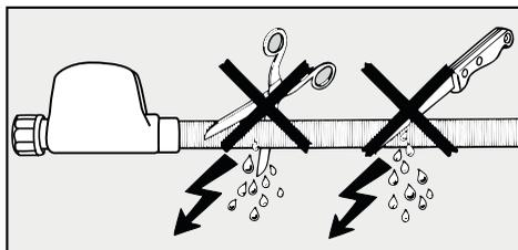
**Не допускается повреждение или порыв защитной оболочки.**
