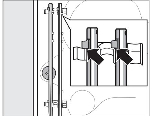
■ Закрепите транспортировочный стержень на задней стенке стиральной машины. Следите за тем, чтобы верхний стопор располагался над креплением.
