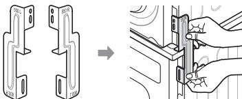
**4** Закрутите в детали комплекта для вертикальной установки два винта, ранее снятых с устройства.
