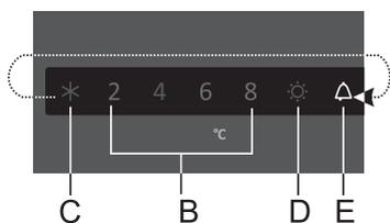
При превышении допустимой температуры в приборе включается прерывистый звуковой сигнал и мигает индикатор **Е**.
