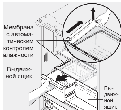
Снятие мембраны с автоматическим контролем влажности
