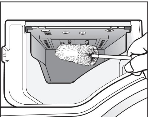
■ С помощью ёршика для мытья бутылок удалите остатки моющих средств и отложения извести с форсунок подачи воды в отсеке.
